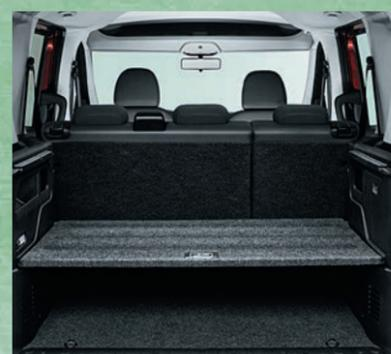
Полка в багажном отсеке может устанавливаться на одну из двух высот и имеет грузоподъемность до 70 кг
